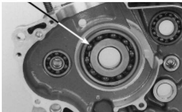
RODAMIENTO DEL CIGÜEÑAL
